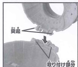
★ リボンパートの穴を取り付け部分に合わせて押し込んでください。
