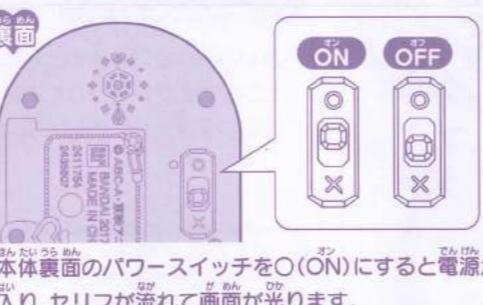
本体裏面のパワースイッチを○(ON)にすると電源が入り、セリフが流れて画面が光ります。
