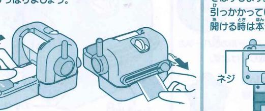
それでも出てこない場合は、本体裏面のふたのネジをプラスドライバーではさみます。ふたを開けるとシリコンロールが取り出せるので、引つかかっている素材を直接取ることが出来ます。本体裏面のふたを開ける時は本体からロールやハンドルを外してから作業してください。
