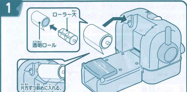
最初に透明ロールに付いている緑のテープをはがします。ローラー大に透明ロールをセットして本体上部に図のような角度でめ込みます。透明ロールの向きに注意してください。
