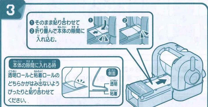
粘着ロールに透明ロールを貼り合わせ、本体の隙間に入れ込みます。
