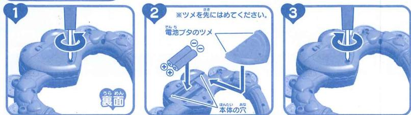
1 本体裏面の電池タのねじを(+) (プラス) または(-) (マイナス) ドライバーで矢印の方向にゆるめ、電池タを取りはずします。
