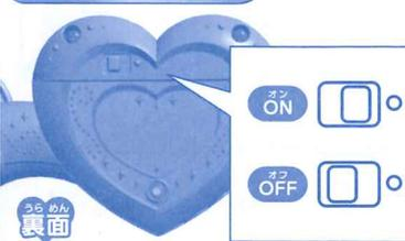
本体裏面のパワースイッチを右側の○のほうにずらすと電源が入り、セリフが流れます。
