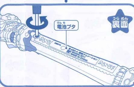
1 本体裏面の電池ブタのねじを+(プラス)または-(マイナス)ドライバーで矢印の方向にゆるめ、電池ブタを取りはずします。
