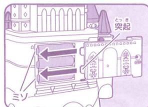
3 電池ぶたを矢印の方向に押し込んで、電池ぶたの突起を電池ボックスのミソにカチッとはめ込んで閉じます。
