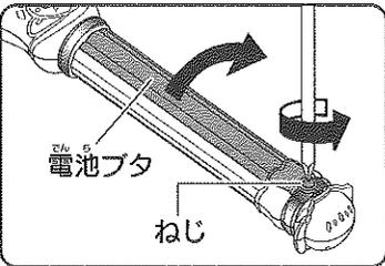
1 電池プタのねじを、⊕(プラス)または⊖(マイナス)ドライバーで矢印の方向へ回してゆるめ、電池プタを外します。
