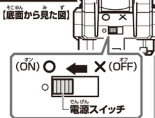
※絶縁シートを取り外して電源を O(ON) にしても動作をしない場合は、下記を参考に一度電池ぶたを開けてボタン電池を装填しなおしてください。
