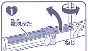
電池ぶたのねじをドライバーで矢印の方向へ回してゆめ、電池ぶたを外します。
