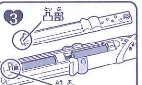
電池ぶたを閉じるときは、電池ぶたの凸部をStick 1の凹部に先にはめてから、1と逆の手順でしっかりと閉じてください。
