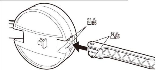
尻尾パーツの付け根を持ち、凸部と凹部を合わせて、矢印の方向に「バチン」と音がするようはめてください。尻尾パーツの入れる向きに注意してください。
